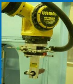
**Usinage de pièces :** Grâce à l'utilisation de broches pneumatiques nouvelle génération, chaque outil possède sa propre motorisation. L'encombrement réduit permet une meilleure accessibilité. L'ensemble de l'usinage s'effectue sur une surface réduite avec aspiration autonome des poussières.
