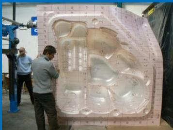
**Thermoformage :** Nous vous proposons une gamme complète de thermoformeuses **MATRAFORM™** permettant un contrôle permanent et précis de l'image de chauffe pour une grande qualité de formage et une répétitivité stricte du processus.
